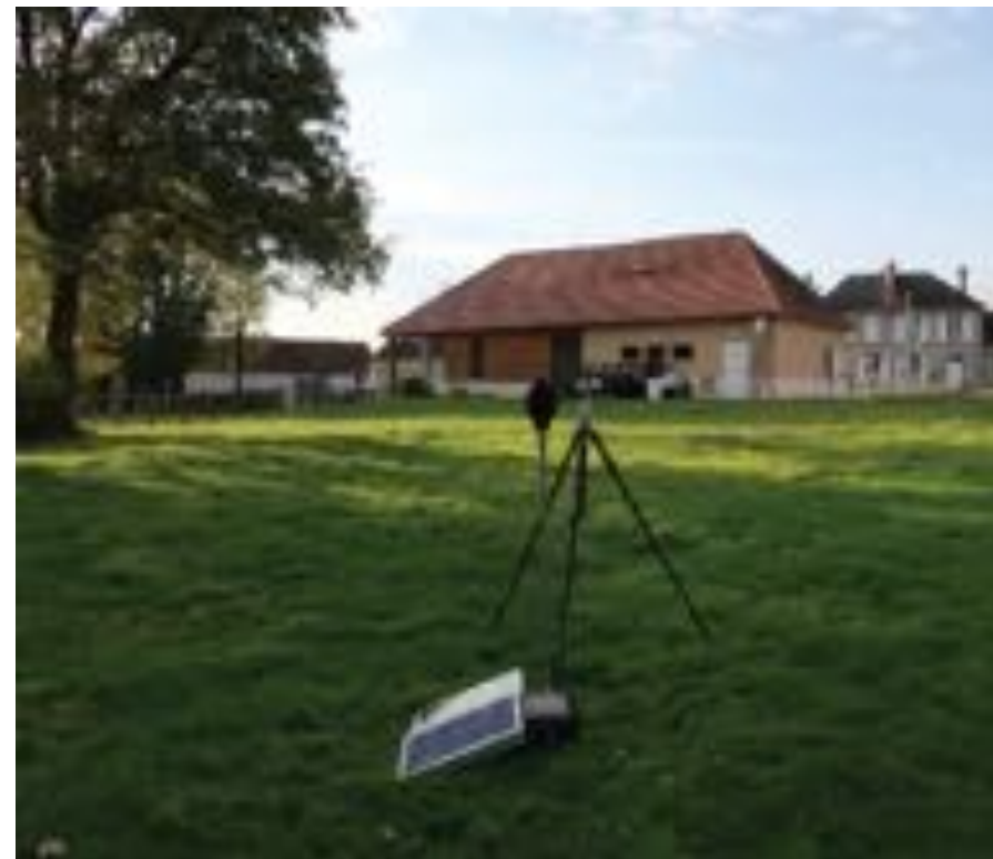
Installation d'un sonomètre et d'un anémomètre près d'une habitation
